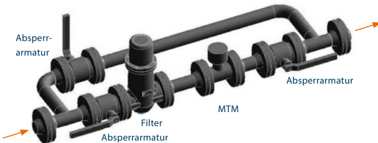
Abb. 2: Typische horizontale Installation des MTM Turbinenradgaszählers
