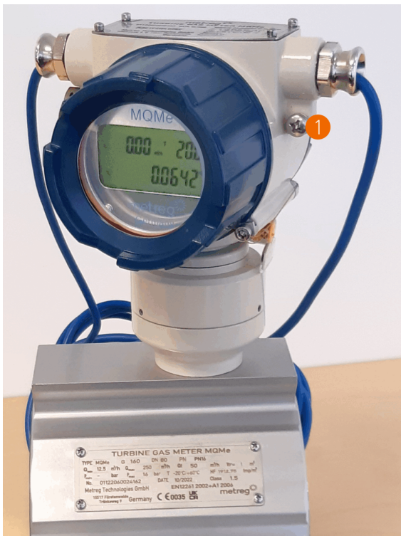
Fig. 4: Connection for the equipotential bonding
